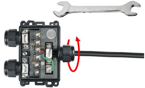
4: Schieben Sie die Rundkabel-Dichtung in die Kabelverschraubung und ziehen Sie die Mutter fest. Maximales Drehmoment 3 N.m.
