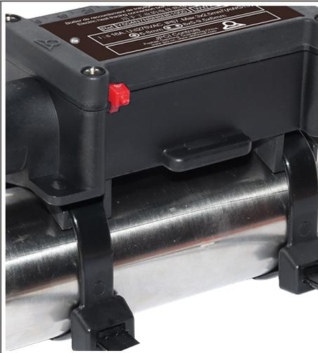
2: Zwei abnehmbare PA66-Kunststofflaschen zum Aufsetzen auf Rohre, mit einem Abstand von 10 mm zum Rohr. Ideal und wirtschaftlich für Anwendungen mit geringer Dämmstärke und Rohrtemperatur unter 100°C. Die Befestigung an Metall- oder PVC-Rohren kann mit Nylonbändern oder Metallschellen erfolgen (Diese Laschen sind im Lieferumfang enthalten).
