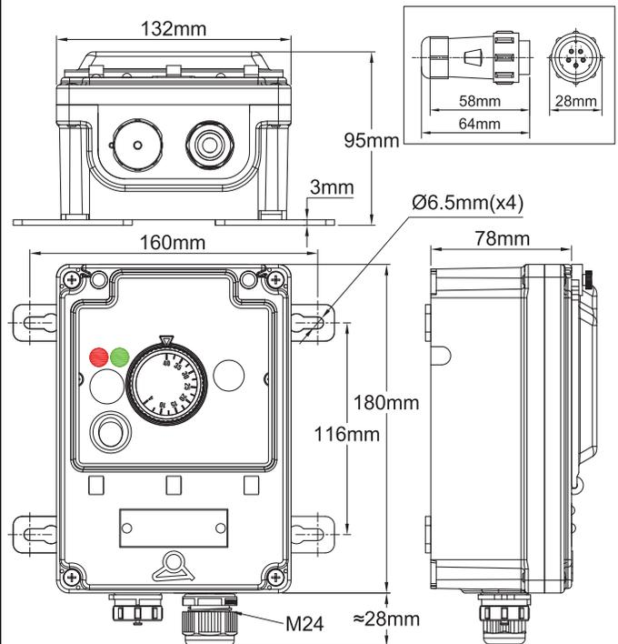
Modell mit 3 Kabelverschraubungen (2 x M24 + 1 x M12):
