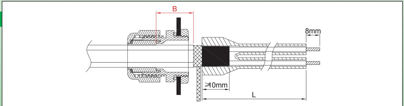
Abstand **B** sollte so gering wie möglich gehalten werden, um eine Erwärmung des Schrankinneren zu vermeiden. Die Länge **L** hängt von der Entfernung zu den Anschlussklemmen ab.
