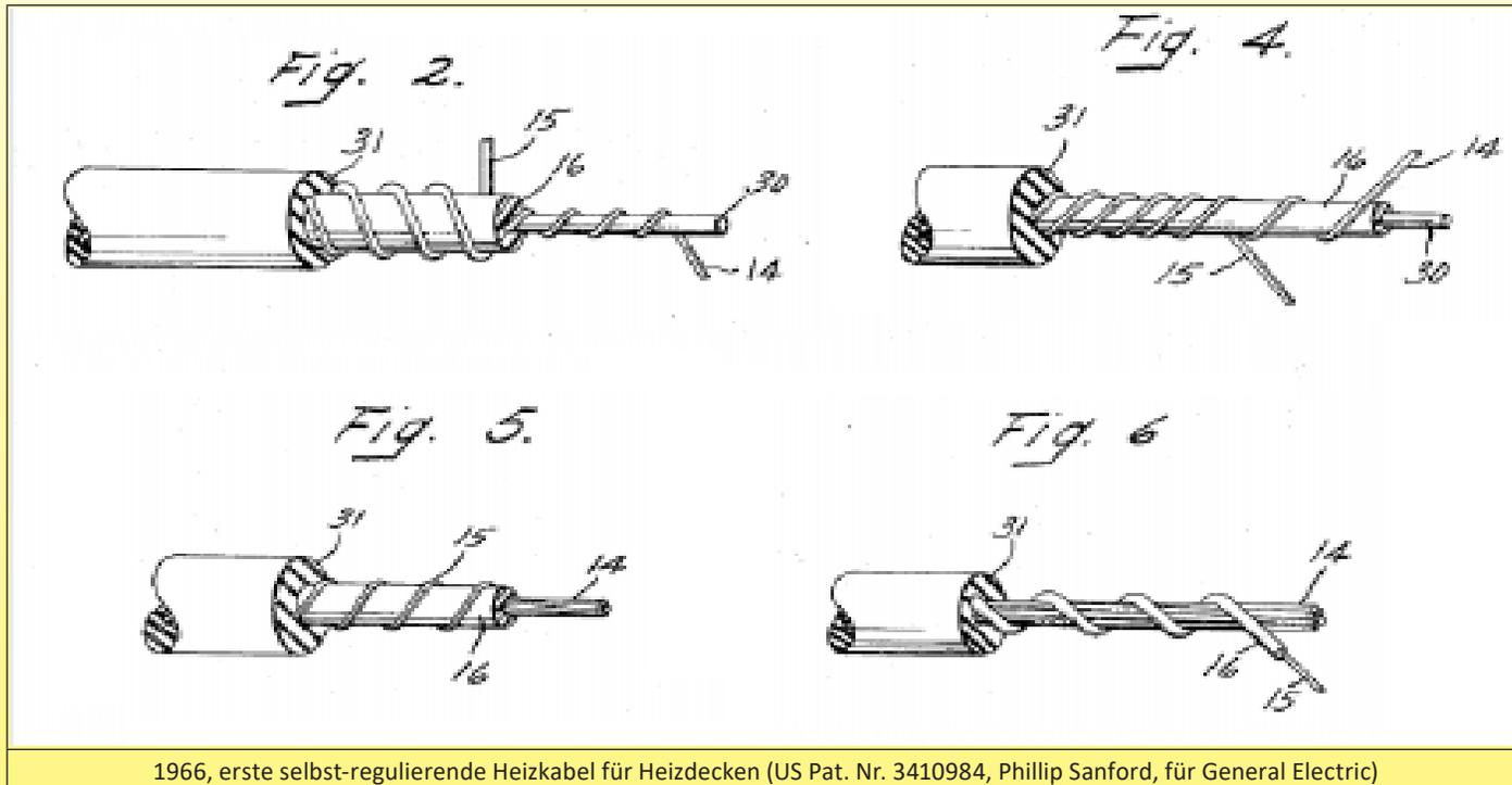
Je nach Zusammensetzung des Polymers, seinem Anteil an Kohlenstoffpartikeln und seiner Dicke konnten unterschiedliche Stabilisierungstemperaturen erzielt werden. Abgesehen von den Kosten führte jedoch die mangelnde Flexibilität dieses hochgeladenen Polymers mit 27% Kohlenstoffanteil dazu, dass die Heizkabel relativ steif waren und nicht die für Heizdecken erforderliche Flexibilität aufwiesen.
