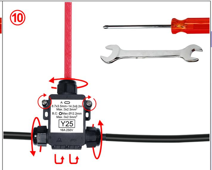
**10** : Schrauben Sie die Muttern der Kabelverschraubung auf den Körper, ohne die Kabel zu drehen. Maximales Anzugsdrehmoment 3 N.m.
