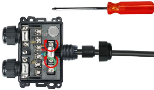
3: Ziehen Sie die Sattelschraube an. Empfohlenes Drehmoment 1,6 N.m.
