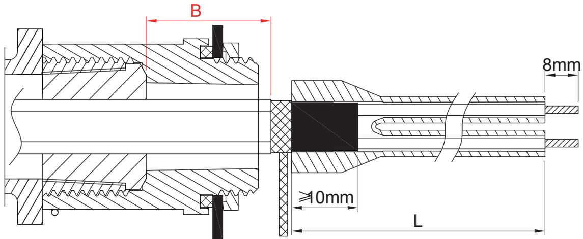
Abstand **B** sollte so gering wie möglich gehalten werden, um eine Erwärmung des Schrankinneren zu vermeiden. Die Länge **L** hängt von der Entfernung zu den Anschlussklemmen ab.
