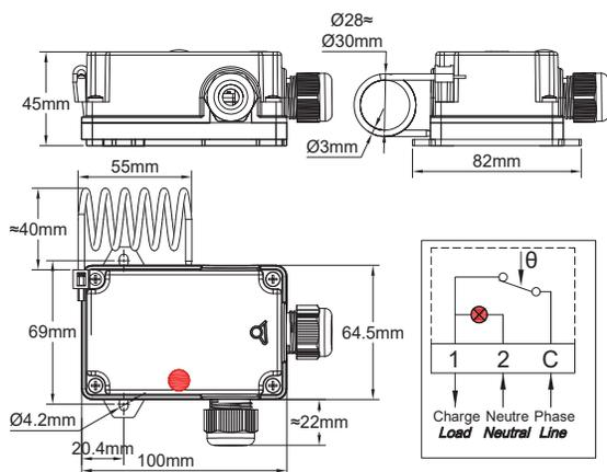
Beispiel eines Modells zur Wandmontage, angeschlossen an Y25-Anschlusskästen zum Frostschutz von Viehgewässern
