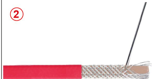
2: Entfernen Sie das Geflecht auf der gesamten Länge mit einem Werkzeug mit abgerundeten Kanten oder einem Schraubenzieher (weitere Details zu diesem Schritt 2 siehe die technische Einführung).
